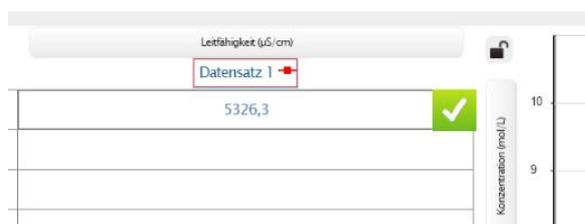
Dadurch wird der erste Wert fixiert und als erster Punkt in dem Graphen eingetragen. Die Anzeige springt in die nächste Zeile. Spülen Sie den Sensor mit destilliertem Wasser,
